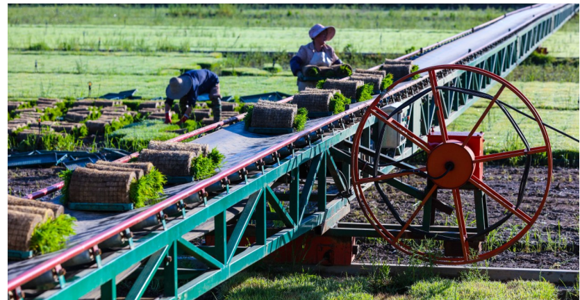
5月5日，在河南省信阳市光山县青龙河合作社，社员用移动式水稻秧苗输送机在田间起秧苗。当日是立夏节气，各地农民抢抓农时开展各项农事活动。新华社发
