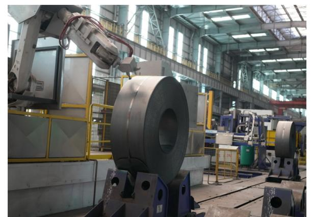
3月24日，唐山市海港经济开发区一家钢铁企业的机器人在刚下线的带钢卷上喷型号代码。
