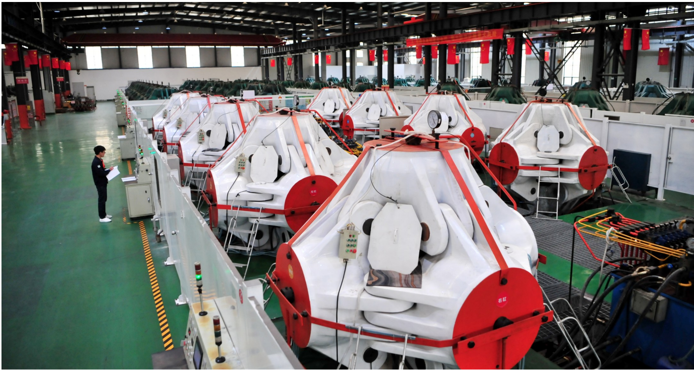
2 月 11 日，湖北省宜昌市夷陵区一家钻石生产加工企业的生产车间里，工人在查看记录自动化设备六面顶压机的实时数据。 新春伊始，各地企业开足马力赶订单、忙生产，力争“开门红”。 新华社发
