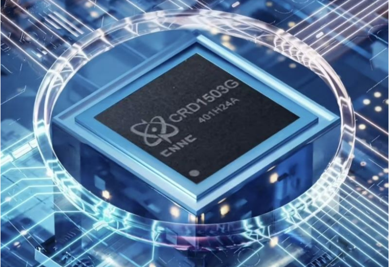
图为X/γ核辐射剂量探测芯片。(中国原子能科学研究院供图)
