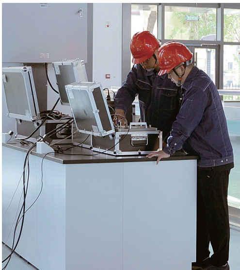
技术人员开展对抗电绕组匝间绝缘试验。
