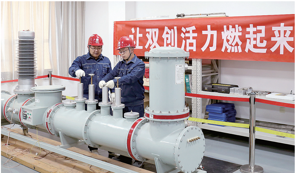
技术人员在实验室开展GIS缺陷模拟实验。
