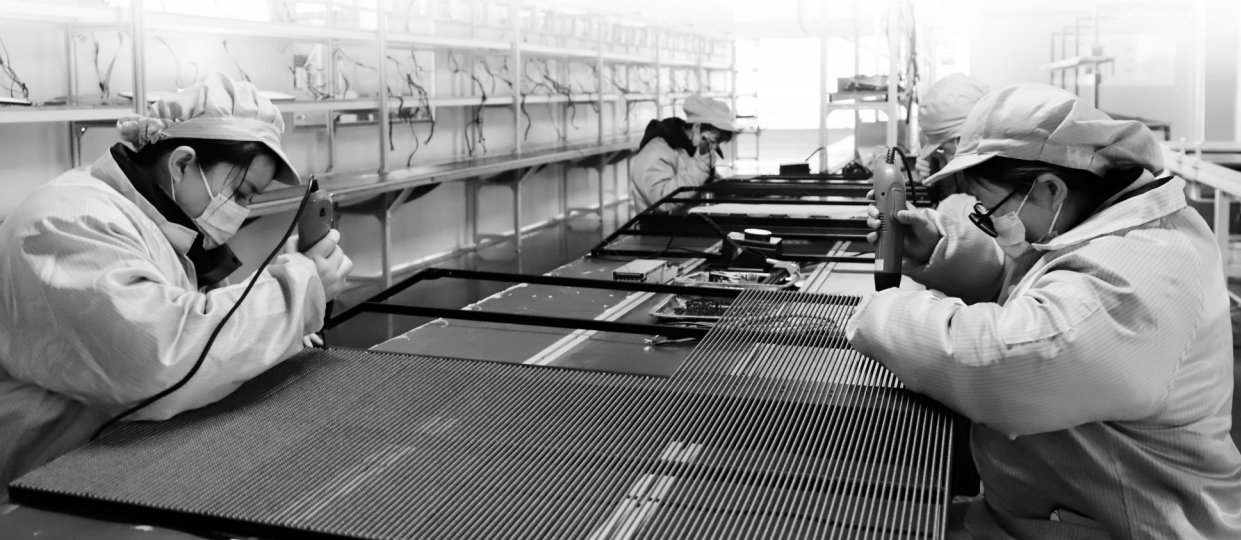
在宁夏荣光科技集团公司的制作车间，工作人员安装LED显示屏。
