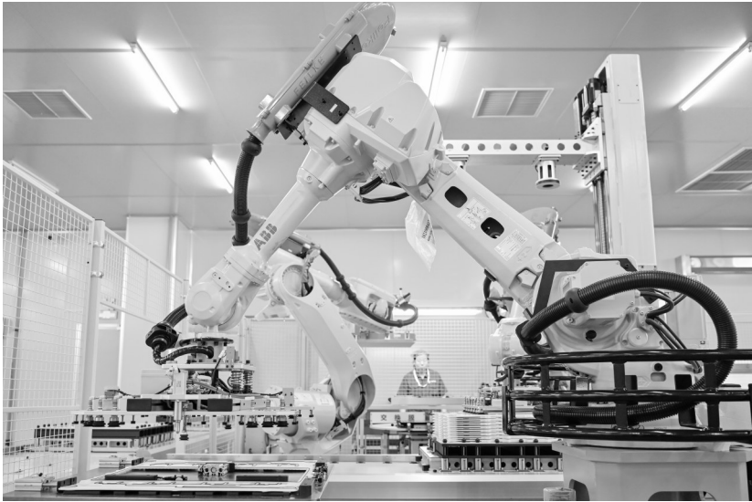
智能机器人在纬景储能盐城智造基地生产车间进行锌铁液流电池电堆总装堆叠作业(9月8日报)。
