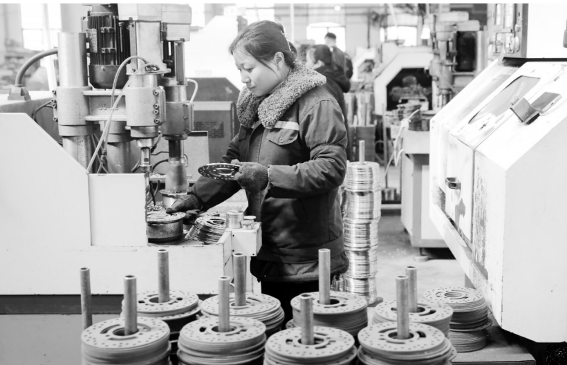
2月28日,在淮北市濉溪经济开发区一家制动部件生产企业,工人在车间生产刹车盘。 近年来,淮北市濉溪县依托新材料产业发展优势,大力引进和发展汽摩配件产业及相关配套产业,积极引进汽摩零部件生产企业入驻,通过专注细分领域,走专精特新之路,用小部件敲开大市场。 新华社发
