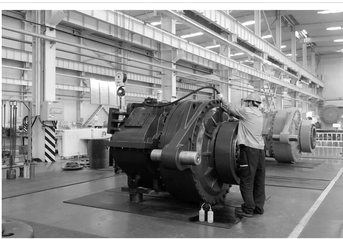
7月12日,在宁夏银星能源股份有限公司生产车间,工人在组装风力发电设备齿轮箱。
