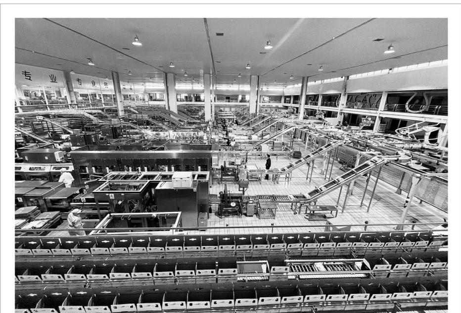
4月7日,在蒙牛乳业(银川)有限公司的自动化生产线,产品被分类装箱。蒙牛乳业(银川)有限公司是以高端液态奶、乳饮料系列产品为主的生产基地,主要产品有特仑苏、未来星儿童成长牛奶、利乐纯牛奶等。该公司于2010年8月奠基,2011年5月正式投产,整体项目总占地面积196.8亩,投资7.7亿元,生产能力为880吨/天,引进德国GEA和瑞典利乐公司成套自动化设备,通过信息化、自动化设备设施的引进,来代替部分人工和手动操作,为提高产品质量安全提供了物质基础。本报记者 陈治学 摄
